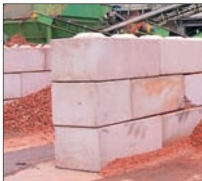
Das **tecSton®-Wand- und Boxsystem**, Bauform S, besteht aus drei aufeinander abgestimmten Modulgrößen im quadratischen Raster von 80 cm, die lose im Versatz universell zu Wänden, Boxen und Hallen gestapelt werden können. Die Wanddicke beträgt äußerst stabile 80 cm.
